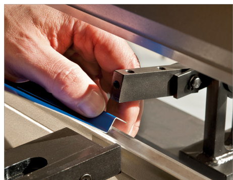
Hinteranschlag klappbar
